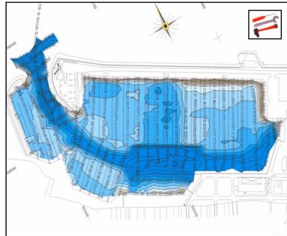
**Figure 6 : cartographie des courbes iso-bathes sur le port d'Arcachon**
